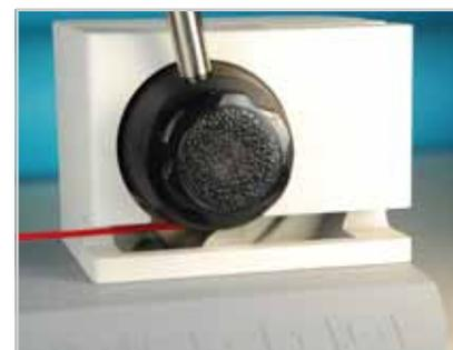
独特的凸轮式设计有力地紧固测量样品的末端
