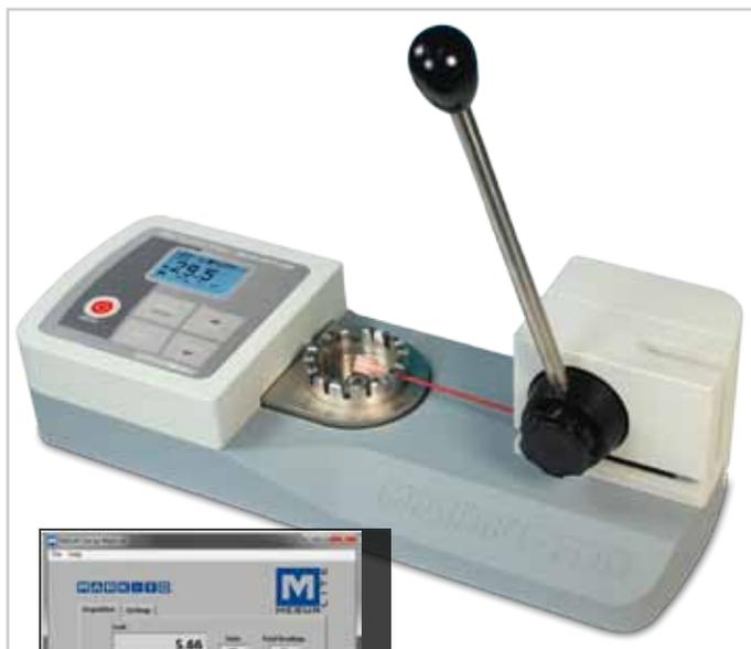
WT3-200接线端子拉力测试仪可测量不同规格端子压接拉力
