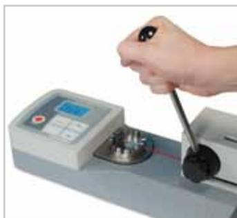
人体工学操控杆用于加载及释放测试样品
